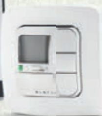
AstroTec-868 1-Kanal-Funkwandsender mit Astro-, Zeit- und Urlaubsfunktion
