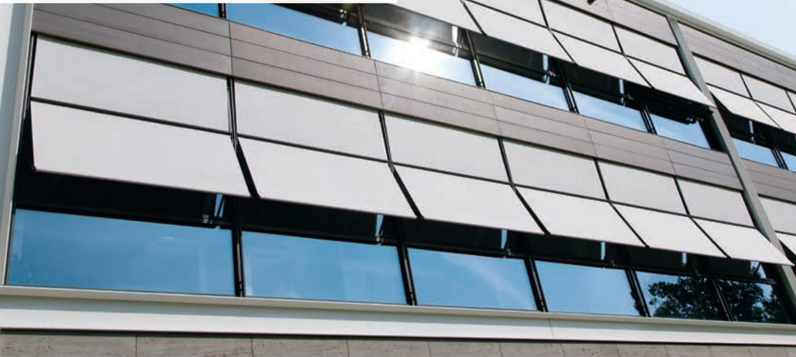
WAREMA Markisoletten stehen für ein attraktives 2-in-1-Konzept zur Gestaltung senkrechter Fassaden: Hochwirksamer Sonnenschutz bei gleichzeitiger Sicht ins Freie sorgen für ein Spiel mit Licht und Schatten. Der obere Bereich der Markisolette verläuft parallel zum Fenster bzw. der Fassade, der untere kann variabel ausgestellt werden.
