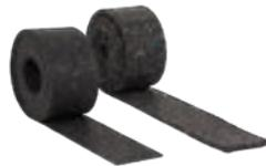
Gummigranulatpads oder -streifen schaffen Abstände zwischen dem Untergrund und den Konstruktionsleisten und ermöglichen dadurch den ungehinderten Abfluss von Wasser bzw. sorgen für Durchlüftung.
