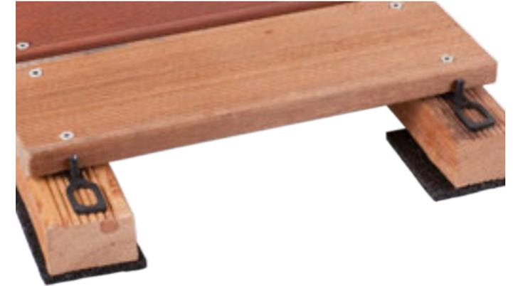
Oberstes Gebot ist es, eine länger andauernde Durchfeuchtung von Holzkonstruktionen zu verhindern und ein rasches Abtrocknen zu gewährleisten. Dies wird durch eine möglichst gut durchlüftete Konstruktion erreicht, bei der die Kontaktflächen zwischen den Hölzern so gering wie möglich sind und kein oder nur wenig Bodenkontakt vorliegt. Bei Dielenstößen müssen 2 Montageleisten verwendet werden, sodass jedes Dielenende auf einer separaten Montageleiste liegt.
