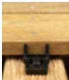
Ventilationselemente wie der „BASO“-Distanzhalter erfüllen eine doppelte Funktion: Einerseits sind sie dafür verantwortlich, dass die Dielen nicht direkt an der Unterkonstruktion aufliegen, andererseits erzeugen sie automatisch ausreichenden Abstand zwischen den einzelnen Dielen selbst. Die Terrasse wird dadurch besser durchlüftet. Positiver Nebeneffekt: Es entsteht ein gleichmäßiges Fugenbild.
