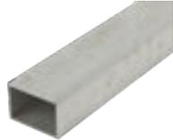
Aluminiumleisten verwendet man bei schwierigen Durchlüftungsbedingungen, z.B. auf Schattenseiten, bei hoher Umgebungsfeuchtigkeit und bei Gefahr von Staunässe. Aluminium ist unempfindlicher gegen Umwelteinflüsse und daher langlebiger als eine Unterkonstruktion aus Holz. Insbesondere wird es für den Bau von Rahmenkonstruktionen auf Flachdächern und Dachterrassen verwendet.
